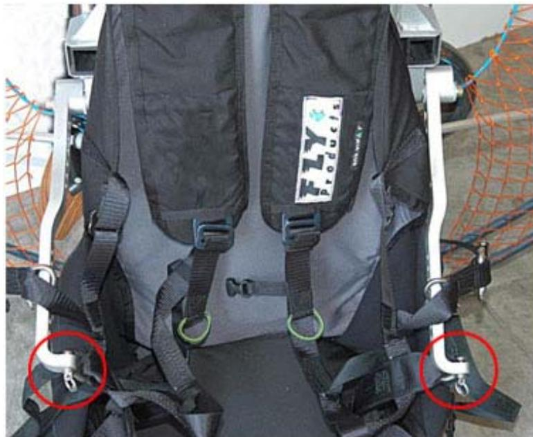
Los puntos de caída de las barras de distancia se realizan fuera del centro para el sistema anti-par y están montados de forma asimétrica como se muestra en la imagen!
