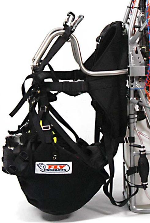
También en este caso los puntos de caída de las barras de distancia se hacen fuera del centro para el sistema antipar y se montan en el modo asimétrico
